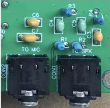
iPhone 上の Sonic Tools のようなオーディオ信号発生器を使用して、CON1-TO SPK ジャックにオーディオ信号を入力します。ボリュームを最大にすると、TX 状態に変わり、TX LED が点灯します。このテストを実行する間、50Ω 負荷抵抗が J1-BNC に接続されていることを確認してください。
