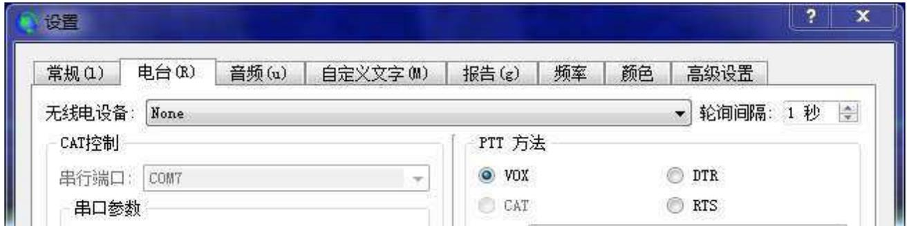
設定インターフェースでは、Radio は [None] を、PTT 方法は [VOX] を選択し、確認のために [OK] を押します。
