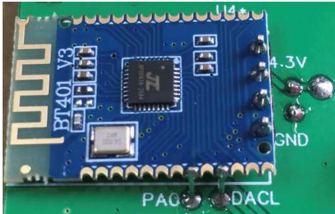
Bluetooth モジュールをテストするためには、まず GND に対して電源電圧が 4.3V 前後であることを確認します。もし測定しているなら、電源電流は約 20mA です。電源投入後、スマートフォンで、ADX-S という名前の Bluetooth モジュールを探して、ペアリングします。オーディオの送受信には、TO SPK と TO MIC の 2 つの端子へのオーディオケーブルは必要ありません。
