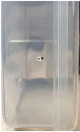
ケースの底の方にボードを入れると、オーディオジャック、電源ジャック、それにUSBポートの穴の位置が決まります。そして、ボードのボタンが底部に当たっていると思います。穴開け位置をマークします。
