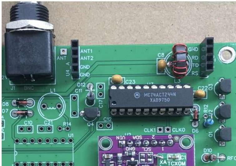
これでTX 送信部の組み立ては終了しました。LPF バンドフィルタ基板を差し込むと、自動的に検出します。警告:ピンを挿し間違えないでください。基板に重大な損傷が発生する可能性があります。すべてのLEDが点灯することにより、間違いに気付くでしょう。
