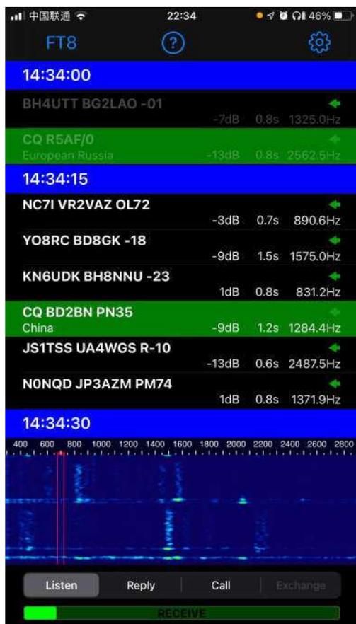
交信を成功させるためには、時刻と周波数を校正する必要があります。ブラウザ中で time.is を入力して、コンピュータの内蔵時計が正確であることを確認します。1 秒以内なら良好です。ADX-S により実際の QSO をする前に、周波数の校正をしてください。送信出力は QRP の範囲内ですので、まず強力な送信局、少なくとも SNR が -5B 以上ある局、を呼ぶことから始めます。その後、さらに弱い信号の局を呼びます。フルサイズのアンテナがあれば、DX 交信を行うことも夢ではありません。
