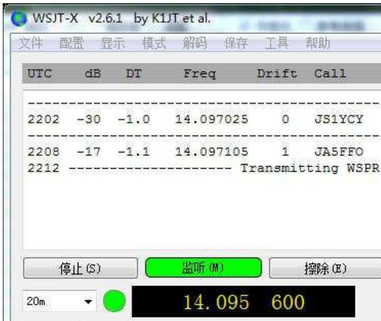
メインウィンドウでは、正しい動作周波数を表示するよう、バンドとモードを手動で設定します。例えば、20m、WSPR を設定すると、周波数は 14.095600 に移動しますが、これは ADX-S のファームウェアの設定と同じです。
