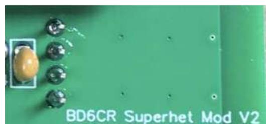
Bluetooth モジュールを差し込み、写真に示すように、4 ピンのヘッダーと 2 つのパッド PA0、DACL を余分のリード線ではんだ付けします。PA0 は Bluetooth モジュールへのオーディオ入力として、DACL はオーディオ出力として機能します。近くのピンとショートしないように注意してください。カバーに対して余分のピンが長すぎたらカットします。
